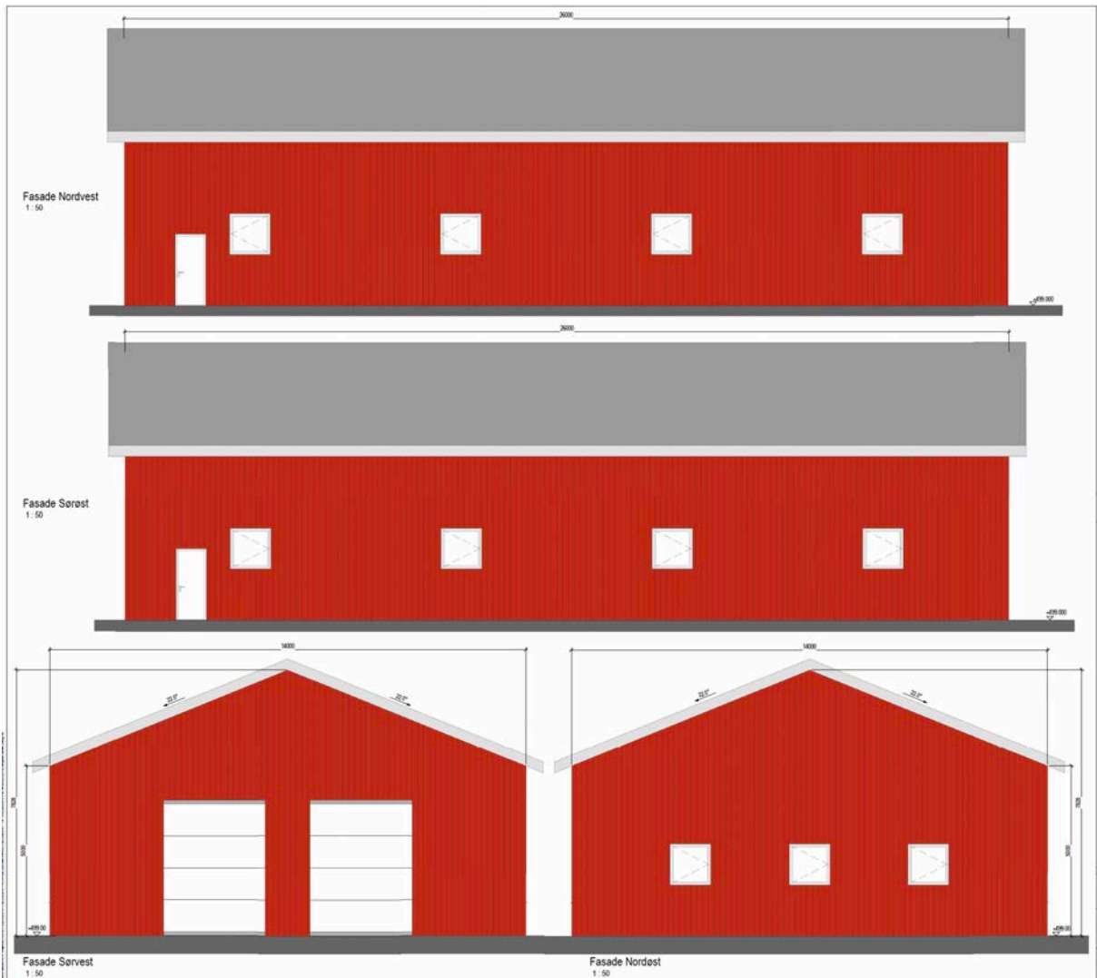
Figur 14 Målsatt bygningskisse for omsøkt bygg til 6MW/12MWh batterianlegg.
